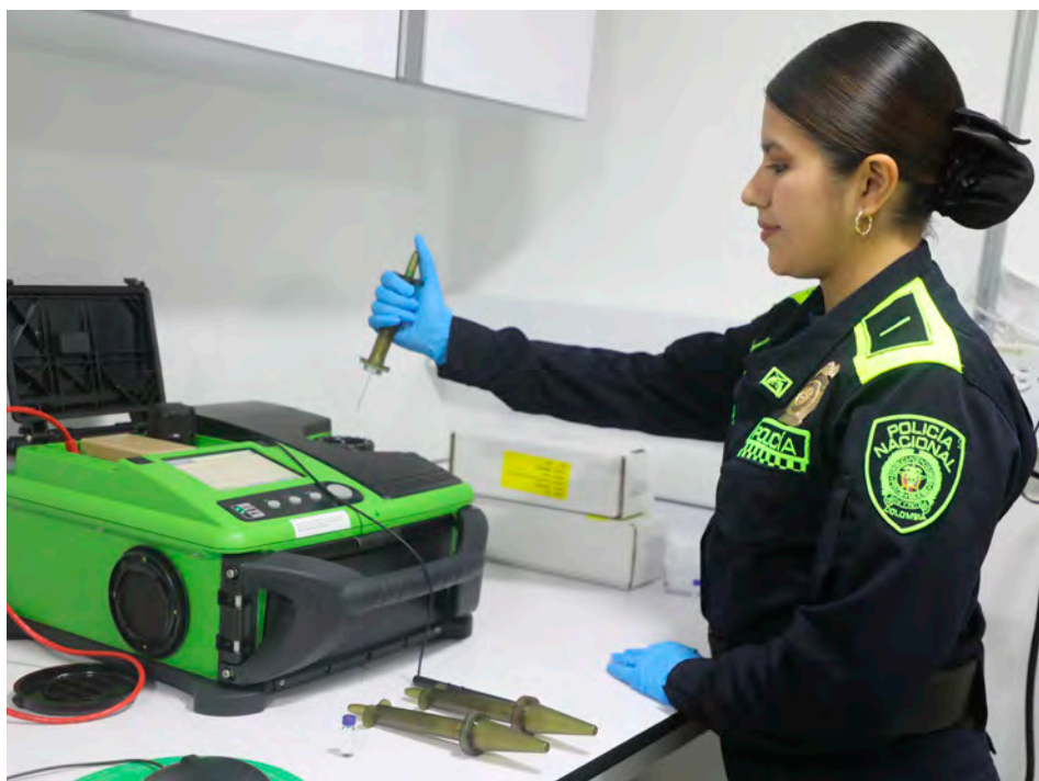
➤ Ilustración 35. Equipo de análisis por cromatografía de gases acoplado a espectrometría de masas portátil
